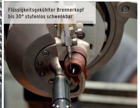
Flüssigkeitsgekühlter Brennerkopf bis 30° stufenlos schwenkbar
