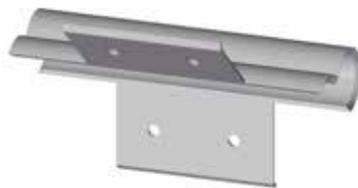
**2** Drücken Sie die Pendelschale über das Rohr.
