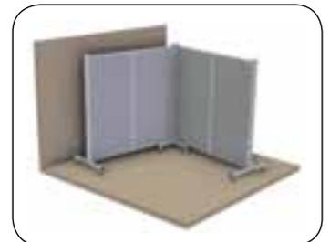
Diese Stellwand besteht aus zwei Sonic Elementen, die in einem fahrbaren Rahmen platziert werden. Die Füsse sind derartig konstruiert, dass zwei Sonic Stellwände eine geschlossene Ecke bilden. So können Sie flexibel, für kurze Zeit Schallschutz an jeder Stelle in Ihrer Werkstatt einrichten. Fahrbar, 4 schwere Lenkrollen mit Bremse. RAL 6011 (mattgrün) oder RAL 7035 (grau) pulverbeschichtet.
