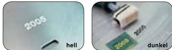
Durch Auftragen des korrosionsfreien Elektrolyts auf die Siebdruckschablonen können Firmenlogos, Seriennummern usw. auf Metallflächen wie z.B. bei Typenschildern und Werkzeugen dauerhaft signiert werden.
