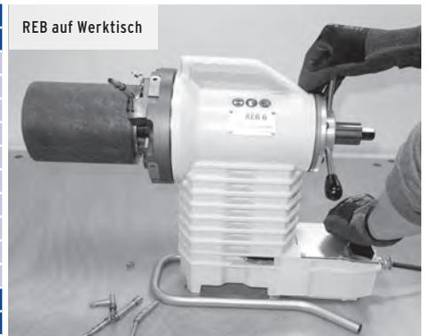
Durch integrierten Griff auch sehr mobil zum Rohr hin einsetzbar
