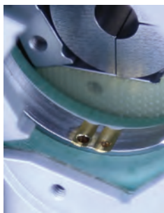
Einfacheres Einsetzen der Elektroden durch Markierungen für Ø 1,0/1,6 mm (0.039"/0.063")
