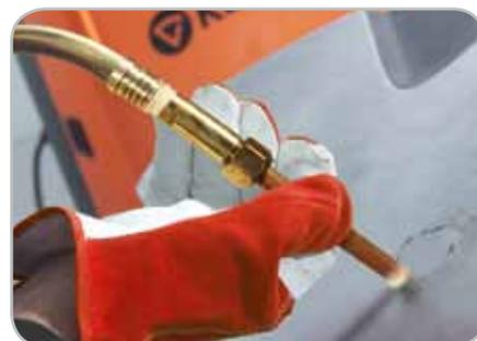
Die HotSpot™-Funktion erleichtert und vereinfacht Metallschrumpfung und Erwärmung einzelner Teile.
