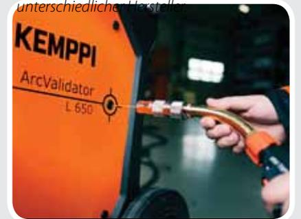
*ArcValidator verfügt zudem über eine integrierte Messvorrichtung für die Drahtvorschubgeschwindigkeit.*
