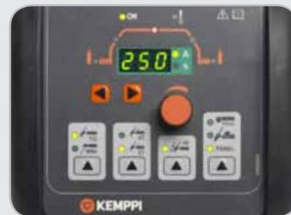
MasterTig LT 250 Bedienpanel: Prozessauswahl für WIG und E-Hand, HF oder Touch-Lichtbogenzündung, Brennerschalterverriegelung und Auswahl eines Fernreglers. Stromanzeige, Einstellung der Gasvor- und -nachströmzeit, Timer für Stromanstieg.
