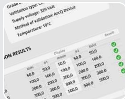
*Die ArcValidator PC-Anwendung verwaltet die vor- und nachgelagerten Aufgaben des Validierungsverfahrens. Sie gewährleistet eine einfache Erstellung des Zertifikats und die Führung präziser Kundenaufzeichnungen.*
