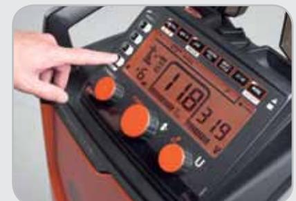
*Die Kemppac Adaptive-Modelle (mit A gekennzeichnet) bieten spezielle Merkmale. Dazu gehören die Stromregelung je nach Blechdicke, Auswahl der Zusatzwerkstoffe und Speicherkanäle.*
