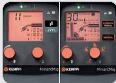
Die Modelle MinarcMig Evo 170 und 200 verfügen über LCD-Bedienpaneele. Die MinarcMig Evo 200 ermöglicht auch die Auswahl der Materialart, Blechdicke und Schweißnahtform.
