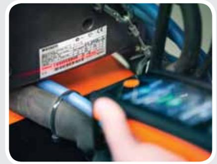
*Der ArcValidator RC zeichnet alle individuellen Daten des Validierungsverfahrens für eine spätere Übertragung auf die PC-Anwendung auf.*
