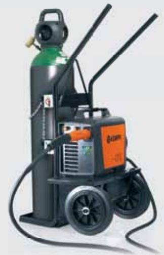
FitWeld 300 befestigt an einem ST7-Fahrwagen
