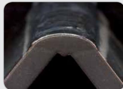
Ein stabiler Lichtbogen sorgt für eine gleichförmige Schweißnaht und gewährleistet gute mechanische Eigenschaften der Schweißverbindung.
