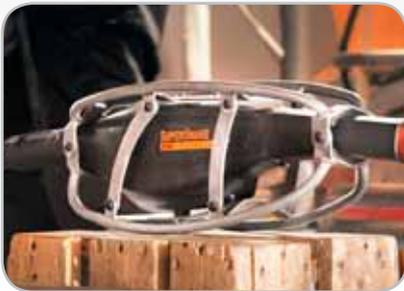
Der robuste Stahlrahmen schützt den SuperSnake vor Baustellengefahren wie zum Beispiel Rückschläge und Unfälle.
