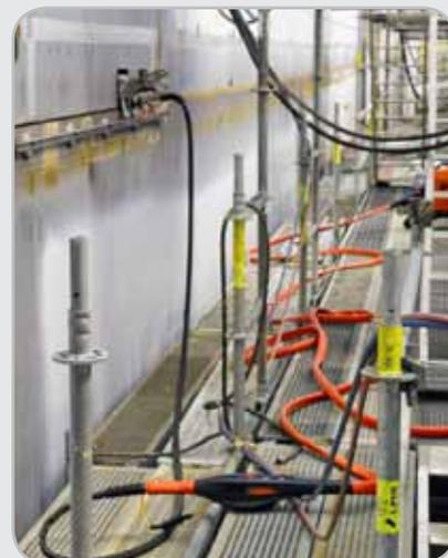
Der MagTrac F 61 ist in vollem Umfang mit dem Kemppi SuperSnake Zwischenrahtvorschubgerät kompatibel, das Ihnen 10 bis 25 m zusätzliche Reichweite ermöglicht.
