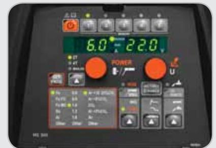
Die synergischen FastMig M Pakete umfassen ein MS-Bedienpanel, das einfach zu bedienende synergische Funktionen sowie eine große Auswahl zusätzlicher Möglichkeiten bietet, um Ihre Schweißarbeiten zu optimieren. Diese Pakete eignen sich für den professionellen Einsatz bei anspruchsvolleren industriellen Anwendungen.
