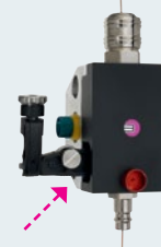
Schritt 5: Wippe mit Gehäusedeckel fixieren
