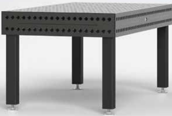
Seitenwange von Professional Extreme 8.7 und 8.8 aus spezifischem Grundwerkstoff S355J2+N inkl. Plasmanitrierung und BAR-Beschichtung.
